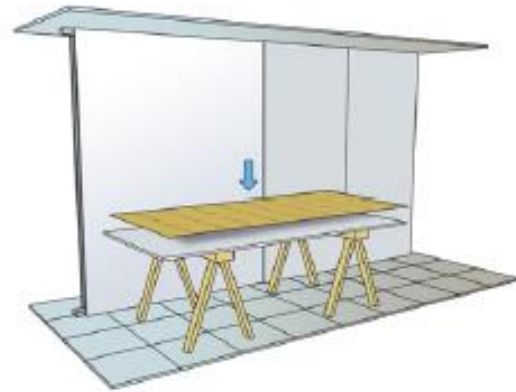
B Poser la membrane sur la plaque de plâtre en position horizontale avec le logo TECSOUND visible.
